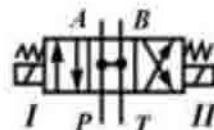
четыrehлинейный трехпозиционный (4/3) с управлением от электромагнитов (соленоидов)
