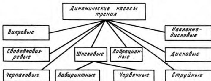
Рис. В.8. Классификация динамических насосов трения
