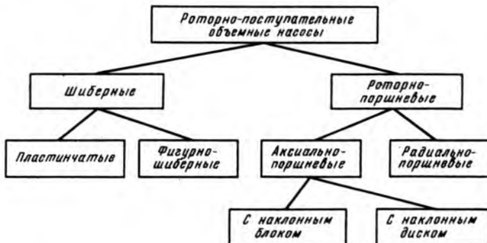
Рис. В.13. Классификация объемных роторно-поступательных насосов
