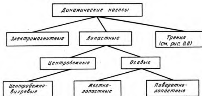
Рис. В. 7. Классификация динамических насосов
