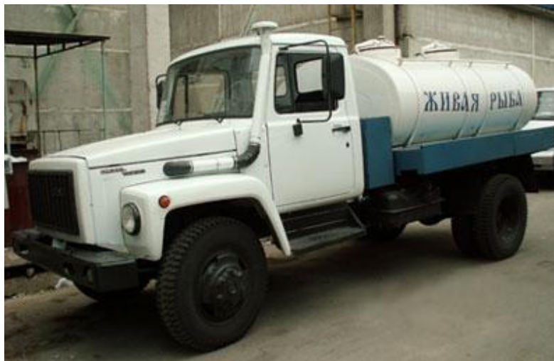
Рис. 60. Автоцистерна АЦП-2,8 смонтирована на шасси автомобиля ГАЗ-53А6
