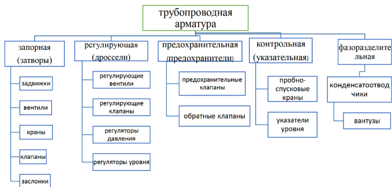
Рис.2.1. Классификация трубопроводной арматуры по назначению
