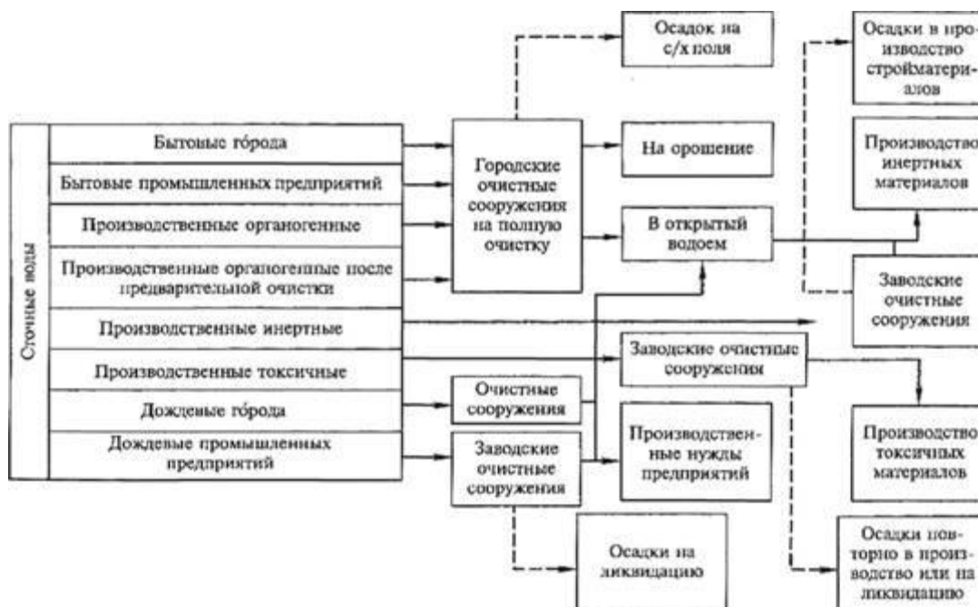
Рис.3.6. Граф возможных вариантов водоотведения и рационального использования очищенных сточных вод при полной раздельной системе
