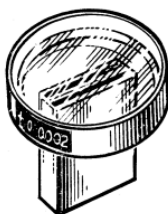
Рис. 6. Интерференционный метод контроля концевых мер
