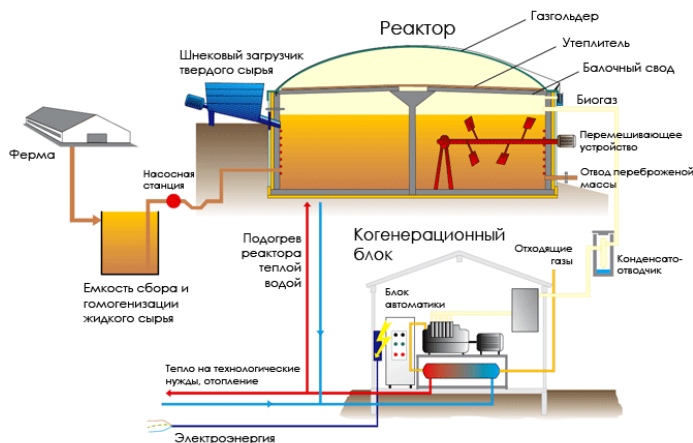
Рис. 1. Технологическая схема процесса производства и использования биогаза
