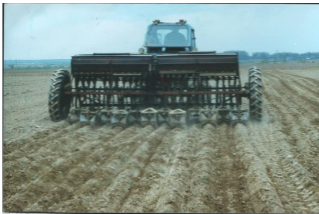
Фото 1. Микрорельефный посев с использованием сеялки СЗУ- 3.6
