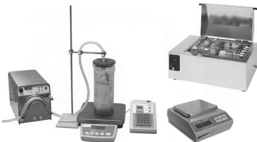
Рисунок 6.4 – Устройство для разбавления спермы SmartDispenser (блок управления с весами и насосом), водяная баня с терморегулятором и циркуляцией воды, лабораторные весы Kern440-47N, 2000 г.
