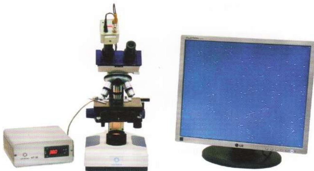
Рисунок 5.6 – Фазово-контрастный микроскоп MBL 2000 с блоком управления, цифровой камерой и монитором
