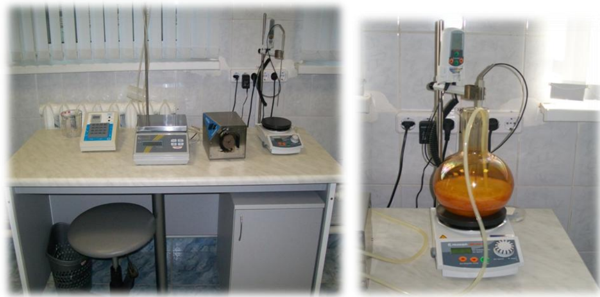
Рисунок 6.1 – Комбинированное устройство для дозировки разбавителя: блок управления SmartDispenser, весы СВ 3К0.5N, насос Ismatec ecoline, подогреваемый столик с магнитной мешалкой Heidolph MR Hei-Tec
