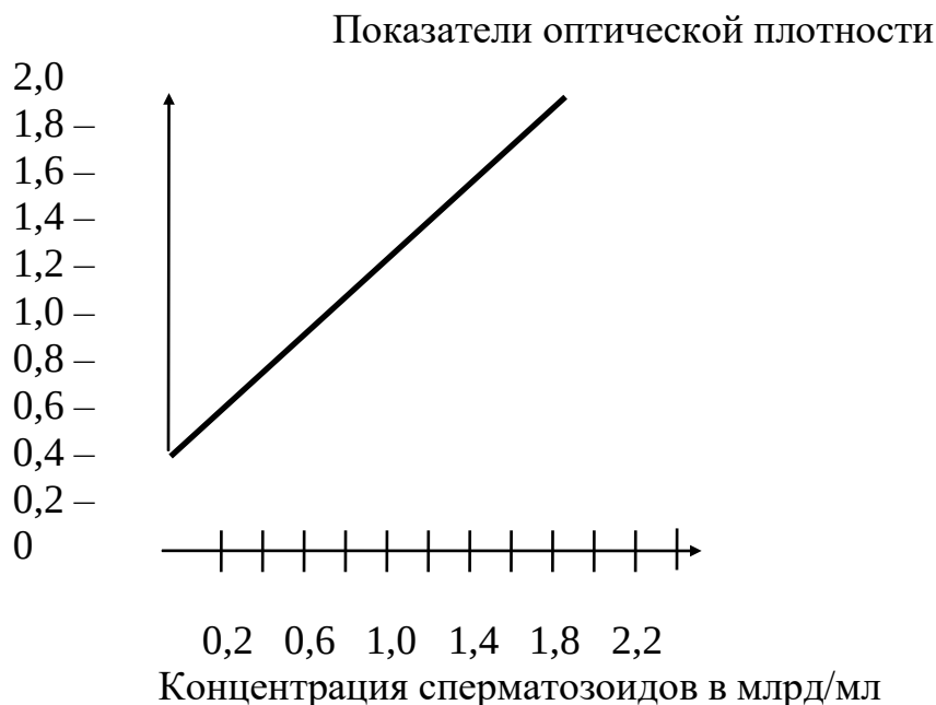
Рисунок 5.3 – Калибровочная кривая для определения концентрации спермы быков на фотоэлектроколориметре
