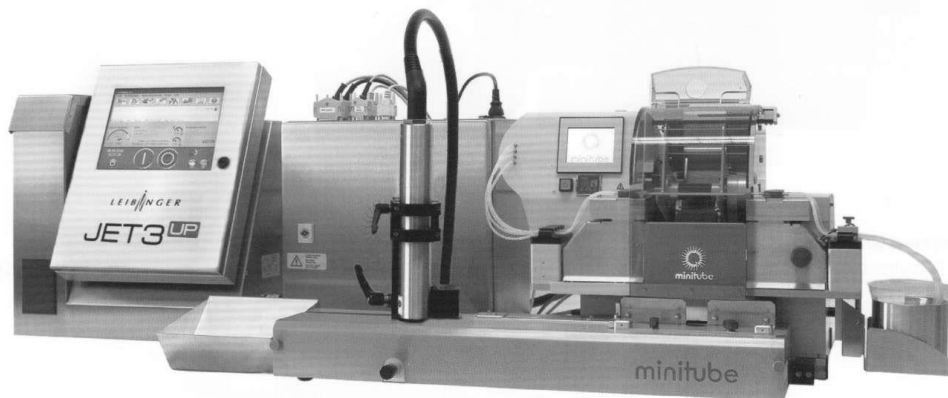
Рисунок 7.4 – Комбисистема для автоматической расфасовки спермы, включает MPP Quattro и MiniJet
