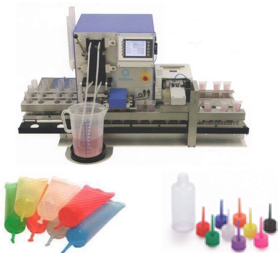
Рисунок 7.3 – Автоматическая фасовочная машина TWINPACKER для фасовки, запайки и этикетирования спермы хряков в тьюбиках, обработка спермы шагом в 2 тьюбика; флекси-тьюбики и бутылочки с крышечками различных цветов
