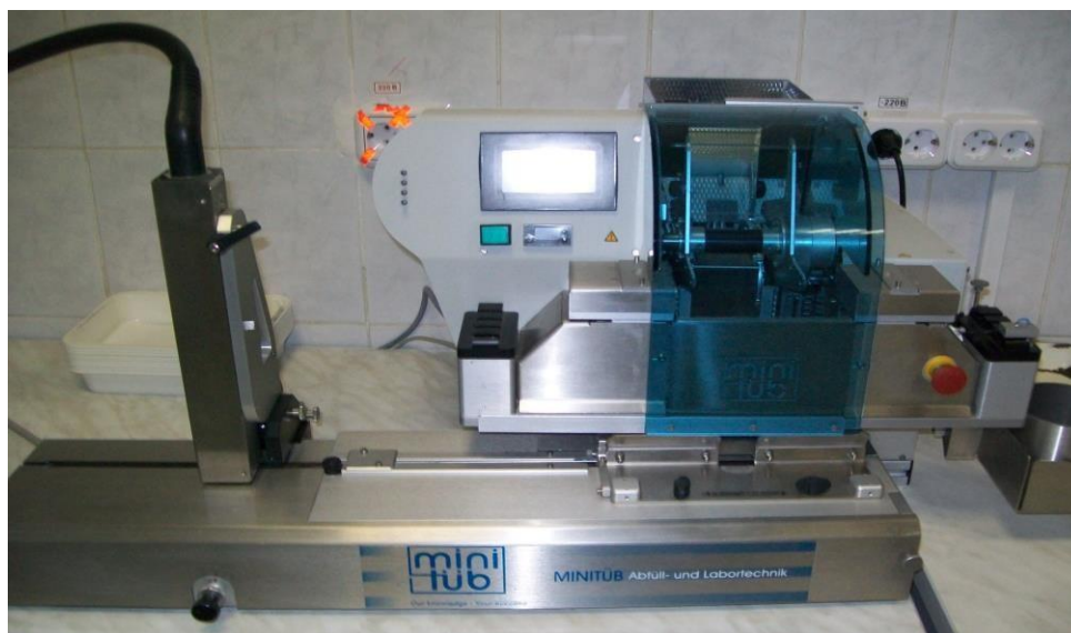
Рисунок 7.7 – Расфасовка и маркировка разбавленной спермы в соломинки струйным принтером для маркировки соломки LEIBINGER-JET2 и фасовочно-укупорочное устройство MPP Quattro (Могилевское госплемпредприятие)
