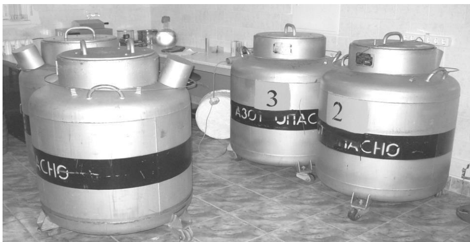
Рисунок 7.10 – Сосуды Дьюара для карантинного хранения спермы
