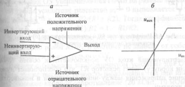
Рис. 4.4. Условный символ для обозначения операционного усилителя на принципиальных схемах (а) и его передаточная характеристика (б)
