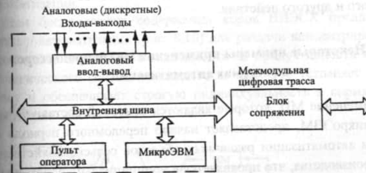
Рис. 8.9. Структурная схема ремиконта
