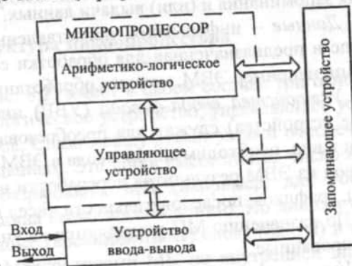
Рис. 8.1. Структурная схема ЭВМ
