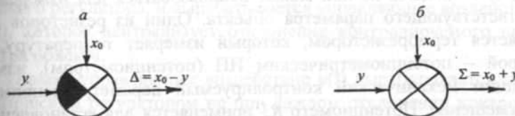
Рис. 3.17. Условное графическое изображение СЭ, реализующих операции: а – вычитания; б – суммирования
