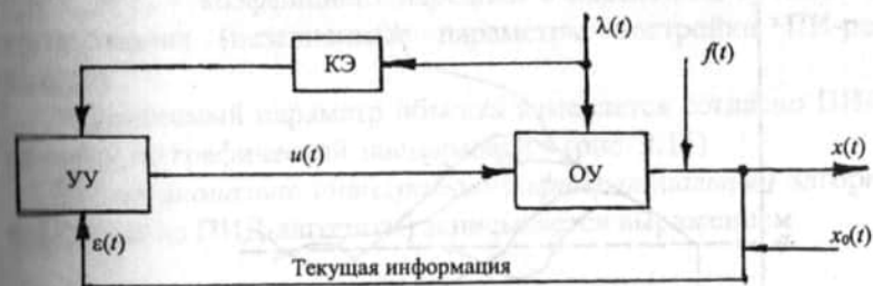
Рис. 2.14. Структурная схема комбинированной системы автоматического управления
