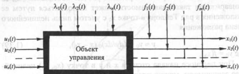
Рис. 1.9. Модель объекта управления в динамическом режиме
