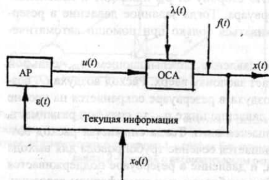
Рис. 2.12. Структурная схема системы автоматизации с принципом управления по отклонению
