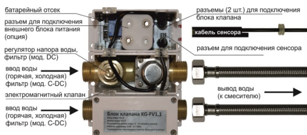
Рис. 12.11. Схема блока управления автоматического смесителя с электромагнитным клапаном
