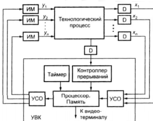
Рис. 18.4. УВК в контуре управления технологическим процессом: x_1 \dots x_n параметры процесса; y_1 \dots y_n – управляющие воздействия; D – датчики, ИМ – исполнительные механизмы
