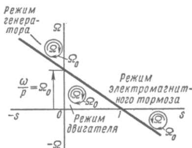
Рис. 17.10. График зависимости угловой скорости вращения ротора от скольжения
