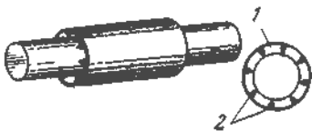
Рис. 16.6. Грязезащитная муфта: 1 – расточенное отверстие; 2 – специальные выступы (2 мм)
