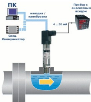
Рис. 4.4. Место установки датчиков давления на трубопроводе
