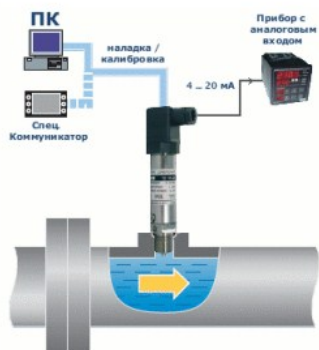
Рис. 4.4. Место установки датчиков давления на трубопроводе
