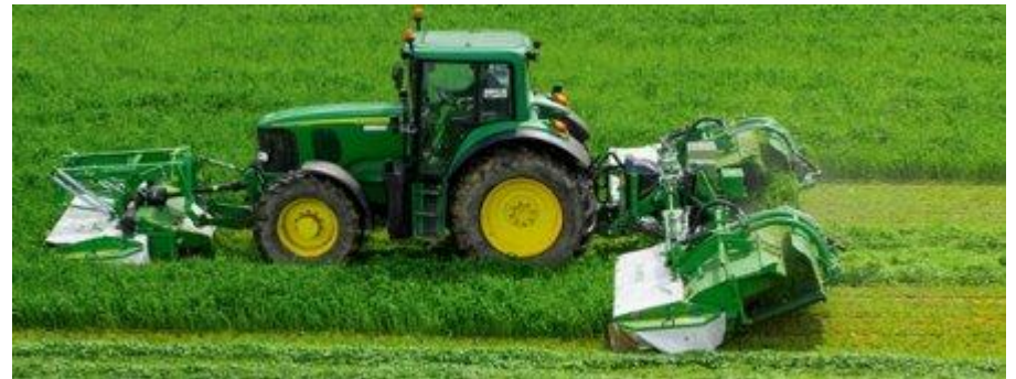
КМР-9 (оснащается: вальцами, кондиционером, транспортерами)
