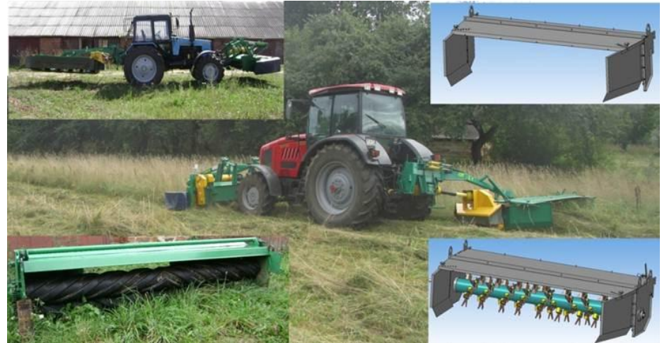
КБМ-6 (оснащается: вальцами, кондиционером)
