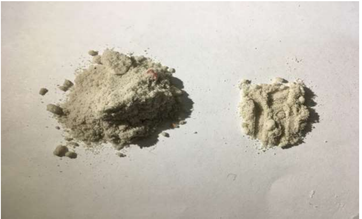
Сульфат калия, сернокислый калий ( K_2SO_4 ) — бесхлорное калийное удобрение, содержит от 46 до 52 % K_2O .
