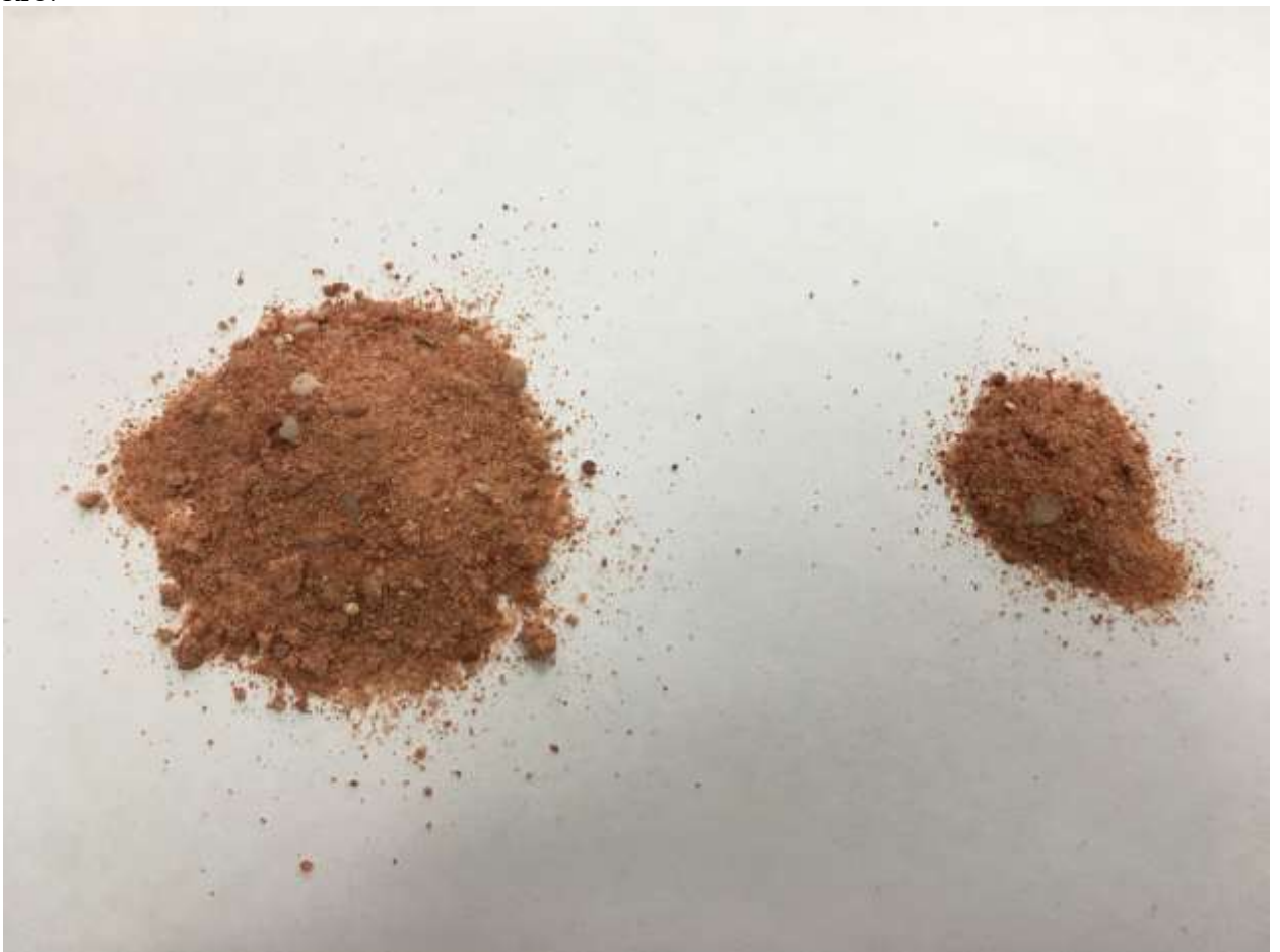
40%-ная калийная соль ( KCl + NaCl ) – продукт механического смешивания хлористого калия с тонко размолотым сильвинитом или каинитом.
