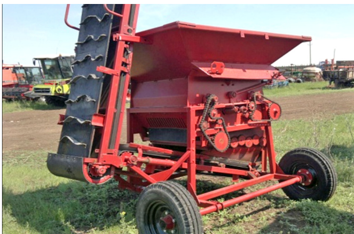
Рис. 7.6. Растариватель-измельчитель минеральных удобрений АИР-20
