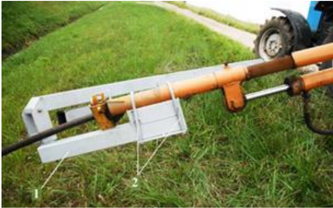
Рисунок 3 – Крепление УНТ- 6 на манипуляторе установки УПД-120: 1 – кронштейн; 2 – хомут.
