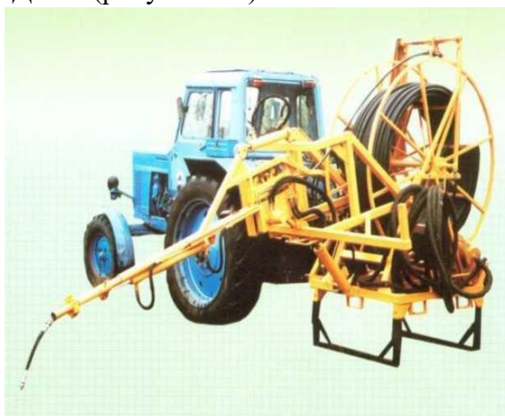
Рисунок 3 – Установка промывки дренажа УПД-120
