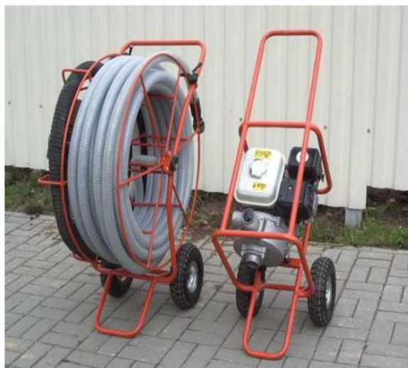
Рисунок 1 – Установка промывки устьевой части коллекторов УПК-30
