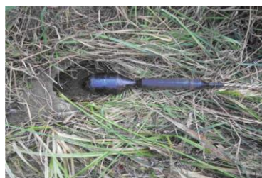
Рисунок 4 – Генератор подачи сигналов на устройство ОД-100 в комплекте с контрольной головкой
