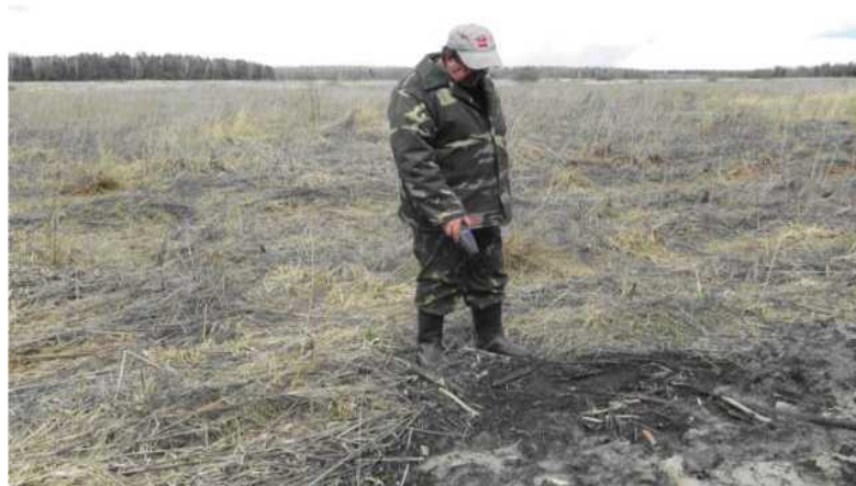
Рисунок 3 – Поиск места неисправности в дренажном коллекторе с применением поискового устройства «TRASKA»
