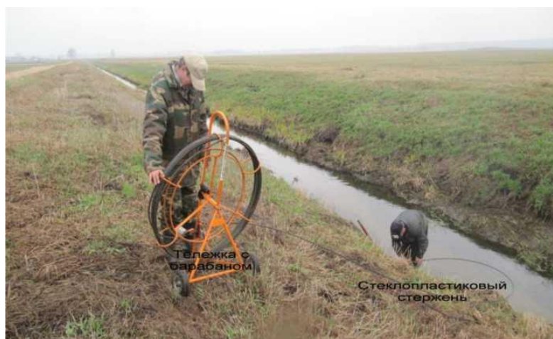
Рисунок 1 – Оценка внутреннего состояния коллектора с применением устройства ОД-100
