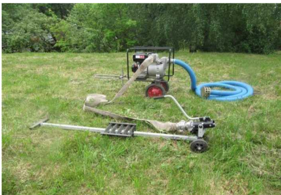
Рисунок 1– Установка промывки трубопроводов УПТ-75
