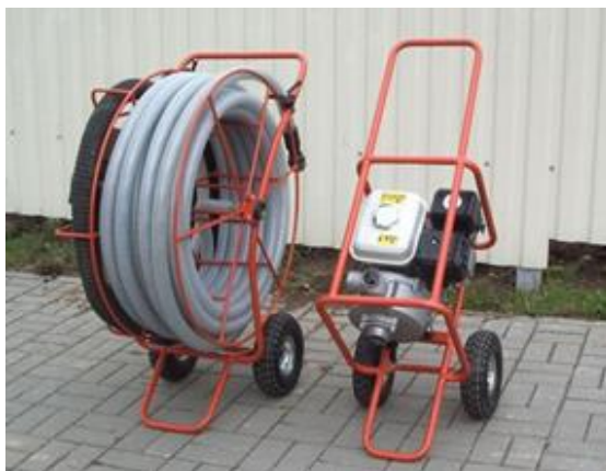
Рисунок 1 – Установка промывки устьевой части коллектора УПК-30
