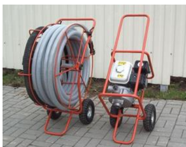
Рисунок 7 – Установка промывки устье-вой части коллектора УПК-30
