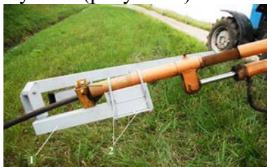
Рисунок 9 – Крепление УНТ- 6 на манипуляторе установки УПД-120: 1 – кронштейн; 2 – хомут.
