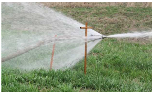
Рисунок 13 – Струи воды, исходящие из головки промывочной
