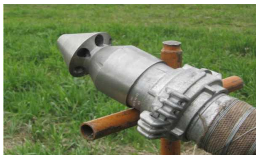
Рисунок 12 – Установка головки промывочной на пожарном рукаве
