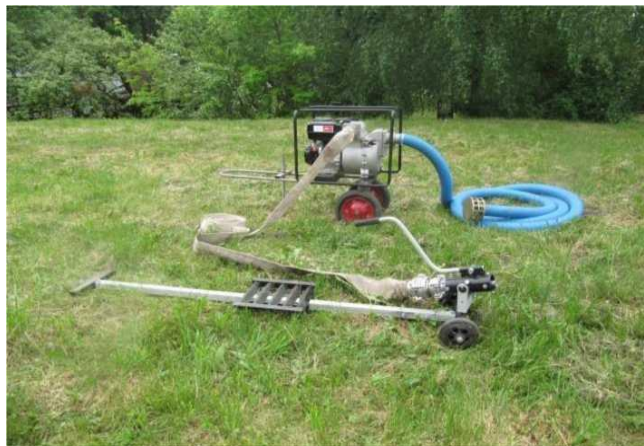
Рисунок 6 – Установка промывки трубопроводов УПТ-75
