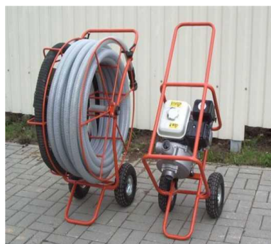
Рисунок 20 – Установка промывки устьевой части коллекторов УПК-30
