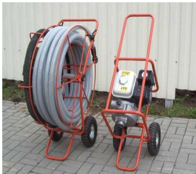
Рисунок 4.20 – Установка промывки устьевой части коллекторов УПК-30
