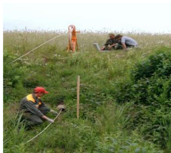
Рисунок 10 – Оценка внутреннего состояния дренажного трубопровода с применением комплекса средств диагностики КСД-160
