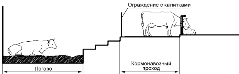
Рис. 1.18. Технологический модуль для беспривязного содержания скота в секциях с заглубленным логовом и несменяемой подстилке
