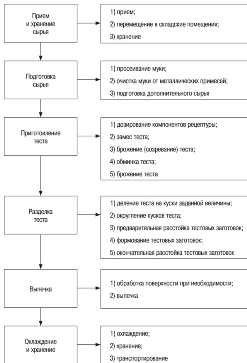
Рис. 2 Технологическая схема производства хлебобулочных изделий
