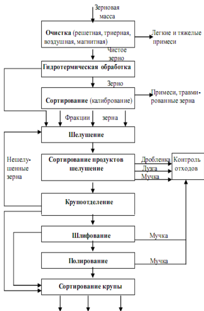
Рис. 1. Технологическая схема производства крупы
