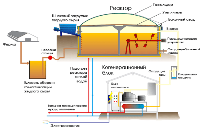
Рис. 1. Технологическая схема процесса производства и использования биогаза
