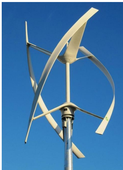
Рис. 6. Ветроустановка с вертикальной осью вращения
