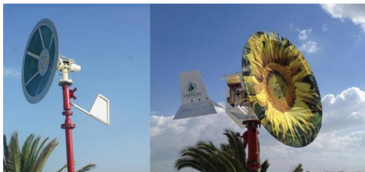
Рис. 4. Ветрогенератор, устроенный по типу парусника
