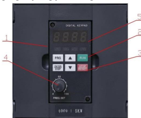
Рис. 11. Управление инвертором: 1 – панель управления инвертора; 2 – кнопка запуска; 3 – кнопка остановки; 4 – регулятор частоты; 5 – индикатор
