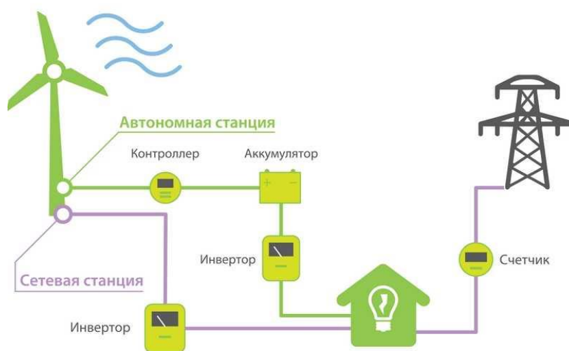
Рис. 2. Схема ветроэнергетической установки
