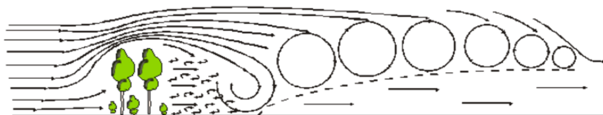
Рис. 12. Влияние полосы ажурной конструкции на движение ветра
