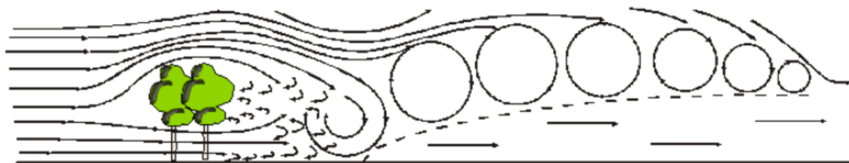
Рис. 14. Влияние полосы продуваемой конструкции на движение ветра
