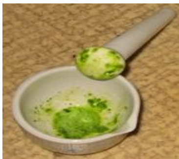
Рис. 13. Измельченный материал с экстракционным буфером
