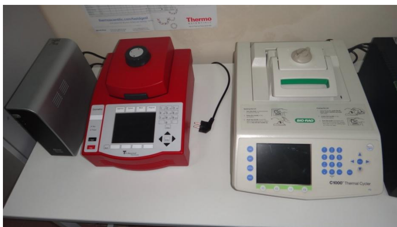
Рис. 8. Амплификаторы для проведения полимеразной цепной реакции
