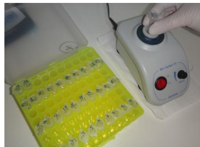
Рис. 18. Перемешивание раствора на вортексе
