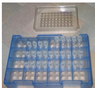
Рис. 24. Подготовка продуктов амплификации для внесения в гель
