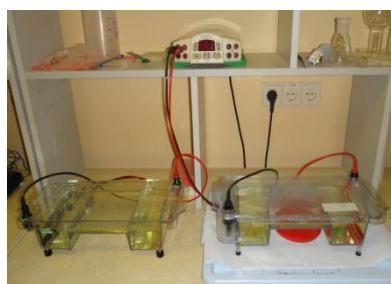
Рис. 23. Камеры для горизонтального электрофореза
