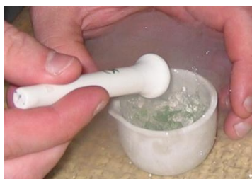
Рис. 12. Измельчение материала при помощи жидкого азота
