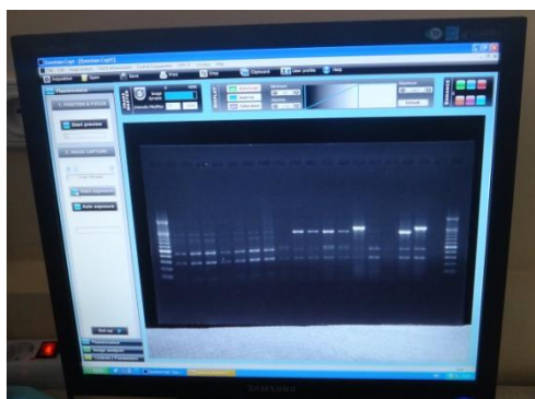
Рис. 29. Изображение флуоресцирующих полос в геле
