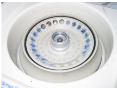
Рис. 15. Равномерное размещение пробирок в центрифуге
