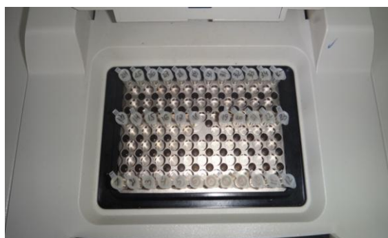
Рис. 21. Постановка пробирок в амплификатор
