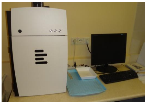
Рис. 28. Трансиллюминатор Gel Doc 2000 и система геле-документирования
