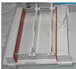
Рис. 22. Заливочный столик с гребенками для агарозного геля
