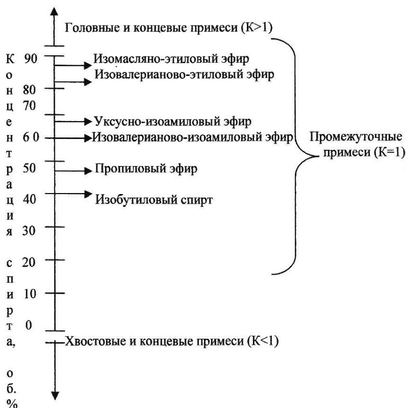
Рис. 31. Примерные концентрации примесей в зависимости от концентрации этанола
