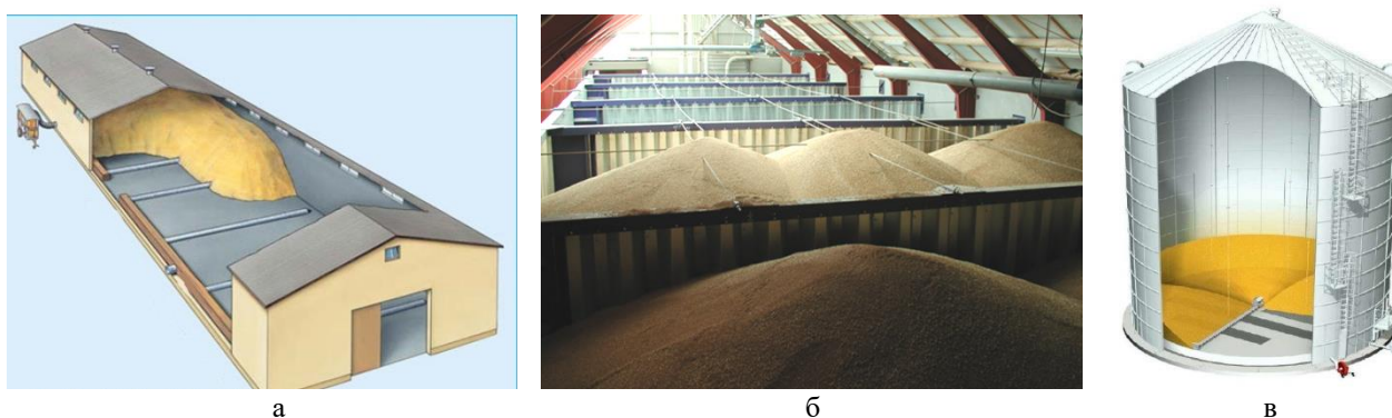
Рис. 13. Способы хранения зерна насыпью: а – напольное; б – закромное; в – силосное
