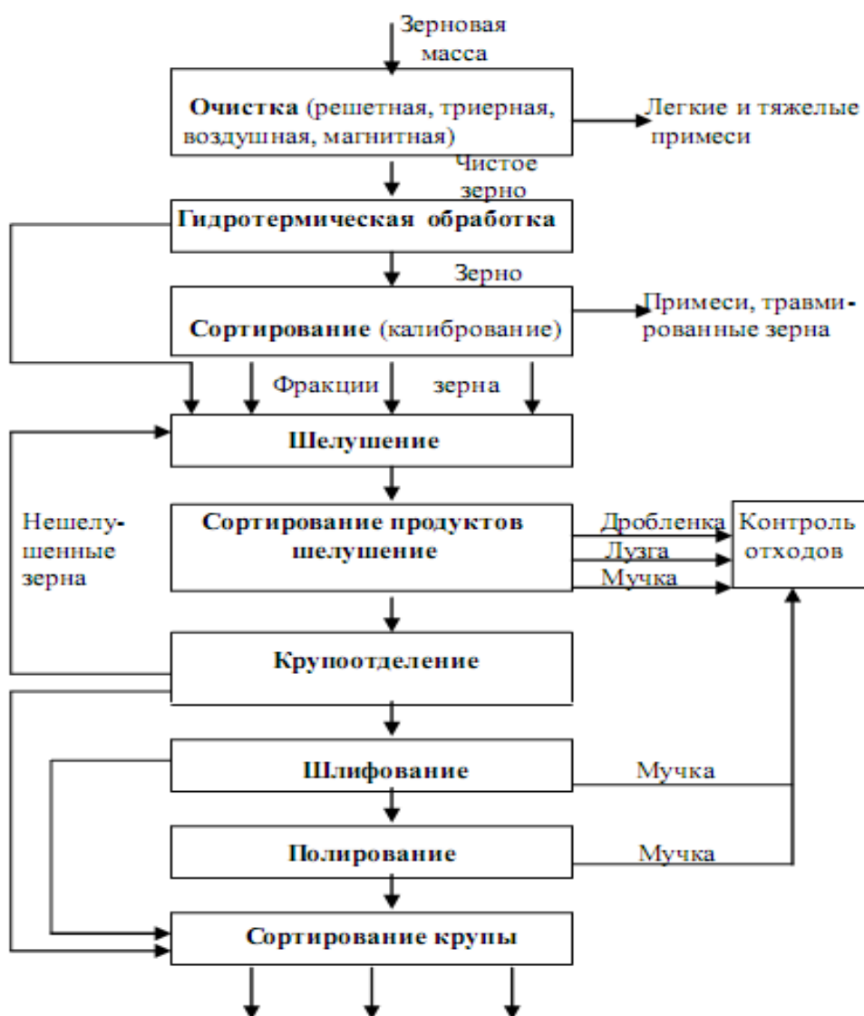
Рис. 22. Технологическая схема переработки зерна в крупу
