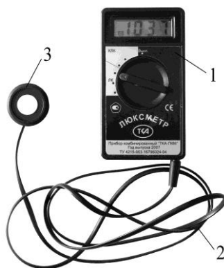
Рис. 1. Внешний вид люксметра «ТКА-ПКМ»/31: 1 – блок обработки сигналов; 2 – кабель связи; 3 – фотометрическая головка
