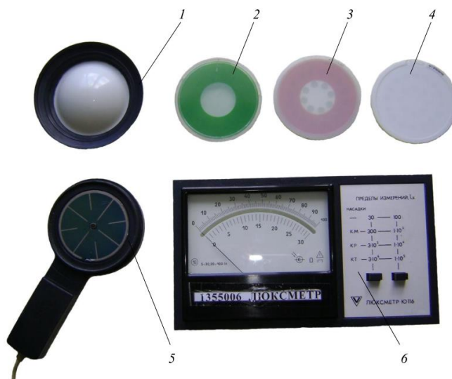
Рис. 2. Внешний вид люксметра Ю-116: 1 – насадка К; 2 – насадка М, 3 – насадка Р, 4 – насадка Т; 5 – фотоэлемент, 6 – измеритель люксметра
