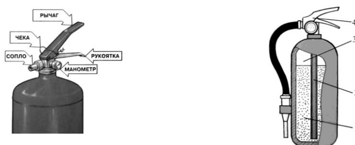
Рис. 2. Огнетушитель порошковый закачной: 1 – заряд (порошок); 2 – сифонная трубка; 3 – рабочий газ; 4 – запорно-пусковое устройство
