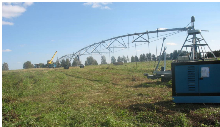
Рис. 6.13. Дождевальная машина Lindsay-Europe Omega 5-1/2 05 OM 510
