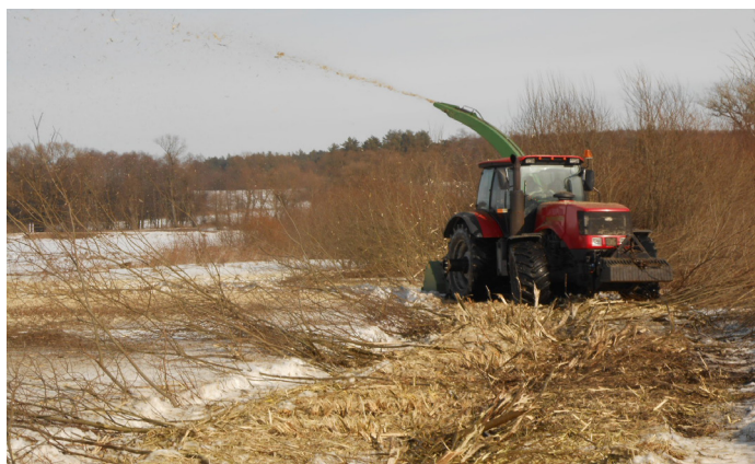
Рис. 5.1. Переработка в щепу древесно-кустарниковой растительности
