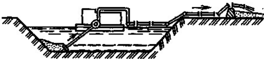
Рис. 5.13. Удаление наносов плавучей землесосной установкой
