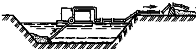
Рис. 4.16. Удаление наносов плавучей землесосной установкой.
