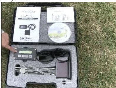
Рис. 3.14. Влагомер почв, песка и грунта TDR -100
