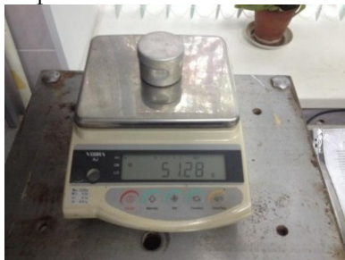
Рис. 7.3. Взвешивание стаканчика с грунтом и крышкой
