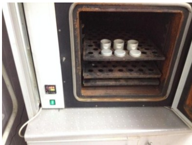
Рис. 7.4. Стаканчики с грунтом и крышками в сушильном шкафу
