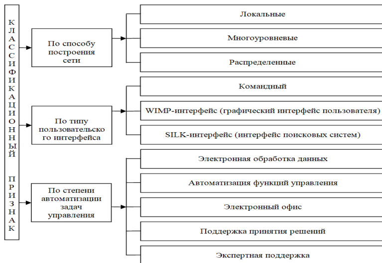
Рис. 1.2. Классификация компьютерных информационных технологий по способу построения сети ЭВМ, типу пользовательского интерфейса и степени автоматизации задач управления
